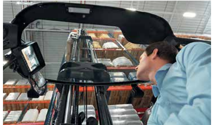
Sécurité: Visibilité de l'opérateur grâce à la vitre de toit blindée
